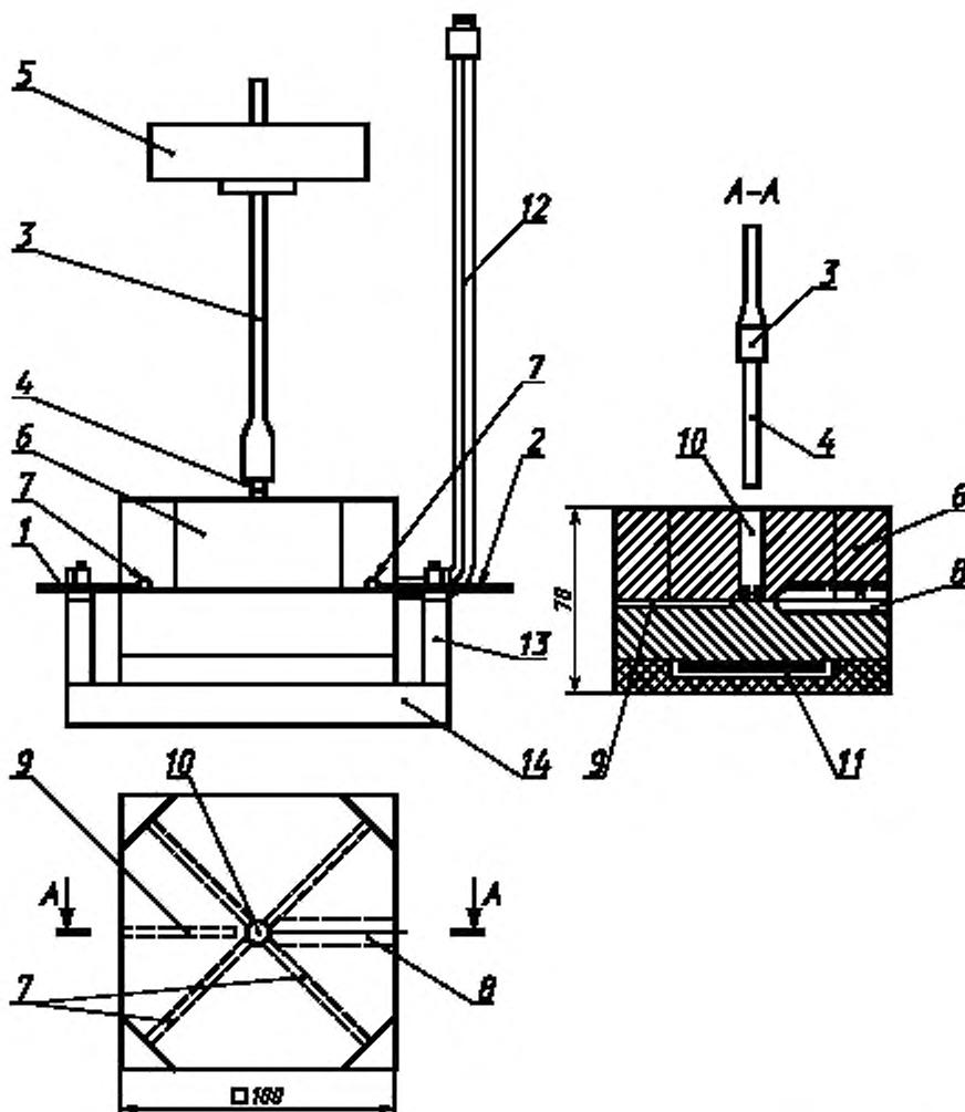
1, 2 — образцы провода; 3 — поршень; 4 — керамическая насадка поршия; 5 — груз; 6 — металлический блок; 7 — прорези для размещения образцов; 8 — отверстие для ввода устройства контроля температуры; 9 — отверстие для ввода термопары; 10 — отверстие для ввода поршия с грузом; 11 — электрический нагревательный элемент; 12 — устройство контроля температуры; 13 — изолированные выводы для присоединения образцов провода; 14 — изолирующее основание
