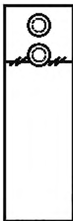
Рисунок Г.14 — Разрушение при сжатии типа LGF: поперечное разрушение по краю крепления, гайки, шайбы (обычно происходит вдоль направления армирования 0^\circ )
