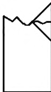
Рисунок Г.8 — Разрушение при растяжении типа MGM: многотиповое разрушение через центр отверстия (сопровождается деламацией и разделением на части)
