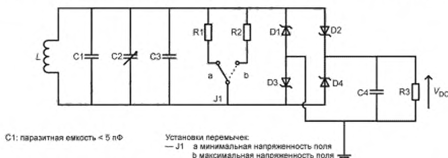
Рисунок F.1 — Принципиальная электрическая схема эталонной радиочастотной метки
