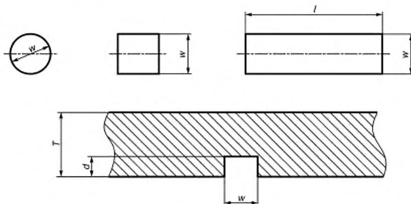
$d$  — глубина отражателя;  $l$  — длина прямоугольного настроочного паза;  $T$  — номинальная толщина стенки;
