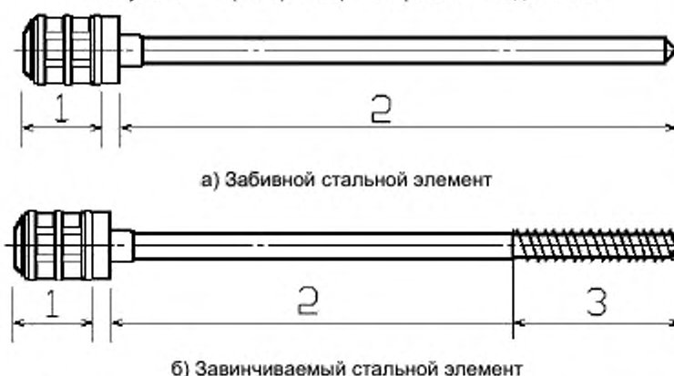
Рисунок 2 — Распорный стальной элемент с теплоизоляционной головкой
