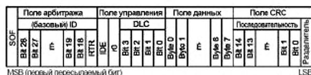
Рисунок 10 — Порядок передачи битов (базовый формат)
