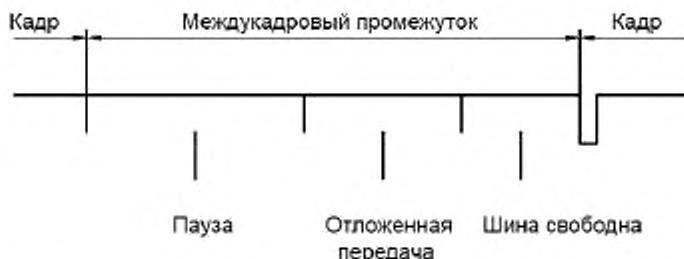
Рисунок 9 — Междукладовые промежутки для узлов, пассивных к ошибкам, которые являлись передатчиками предыдущего кадра
