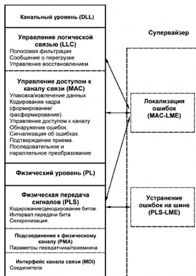
Рисунок 1 — Иерархическая архитектура CAN
