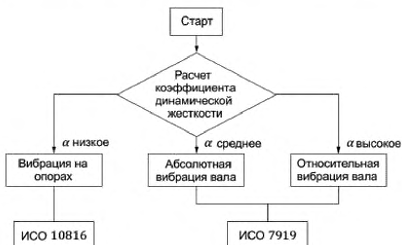
Рисунок 2 — Блок-схема выбора стандарта для измерений вибрации
