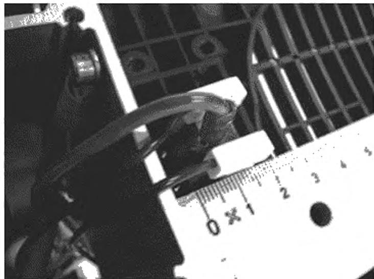
Показанный объект: двигатель в сборке с конденсатором и клеммной колодкой
