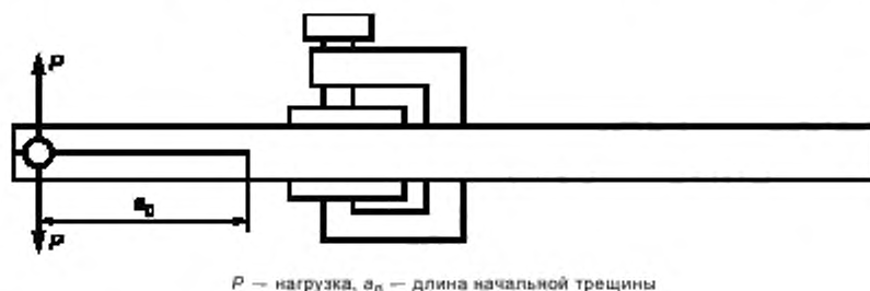
Рисунок 4 — Схема подращивания трещины перед испытанием
