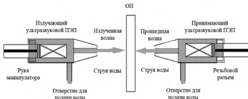
Рисунок 3 — Метод Б. Автоматизированный теневой метод со струйным контактом
