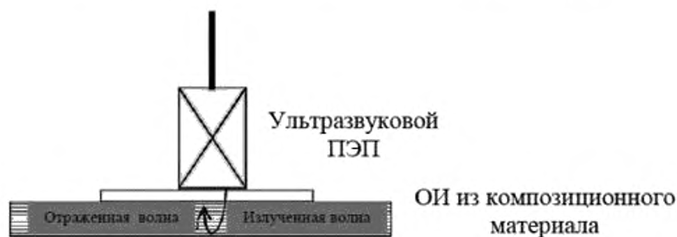
Рисунок 2 — Метод А. Ручной ультразвуковой эхо-импульсный метод
