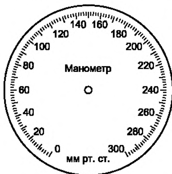
Рисунок 1 — Пример шкалы anerоидного манометра (деление, мм рт. ст., без поля допуска в положении нуля, см. 7.1.4.2.3)
