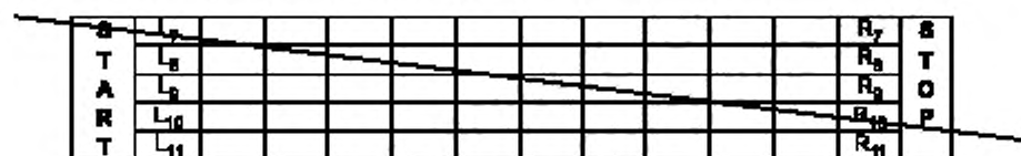
Рисунок К.2 — Схема, представляющая линию сканирования, пересекающую строки
