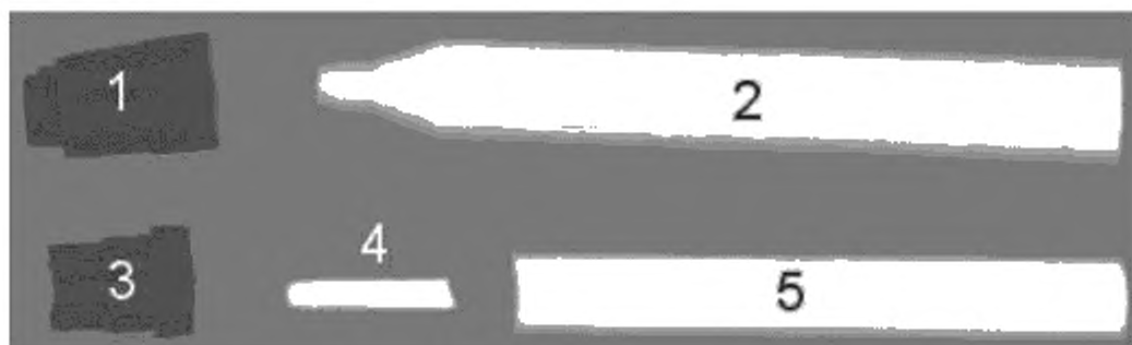
1 — крышка; 2 — корпус ручки; 3 — заглушка; 4 — фетровый наконечник; 5 — тампон.
