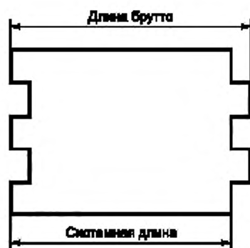
Рисунок А.1 — Размеры изделий с пазогребневым соединением
