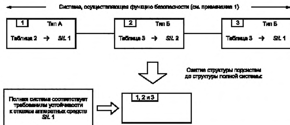
Рисунок 4 — Пример ограничения полноты безопасности АС для одноканальной структуры E/E/PE-системы, реализующей функцию безопасности
