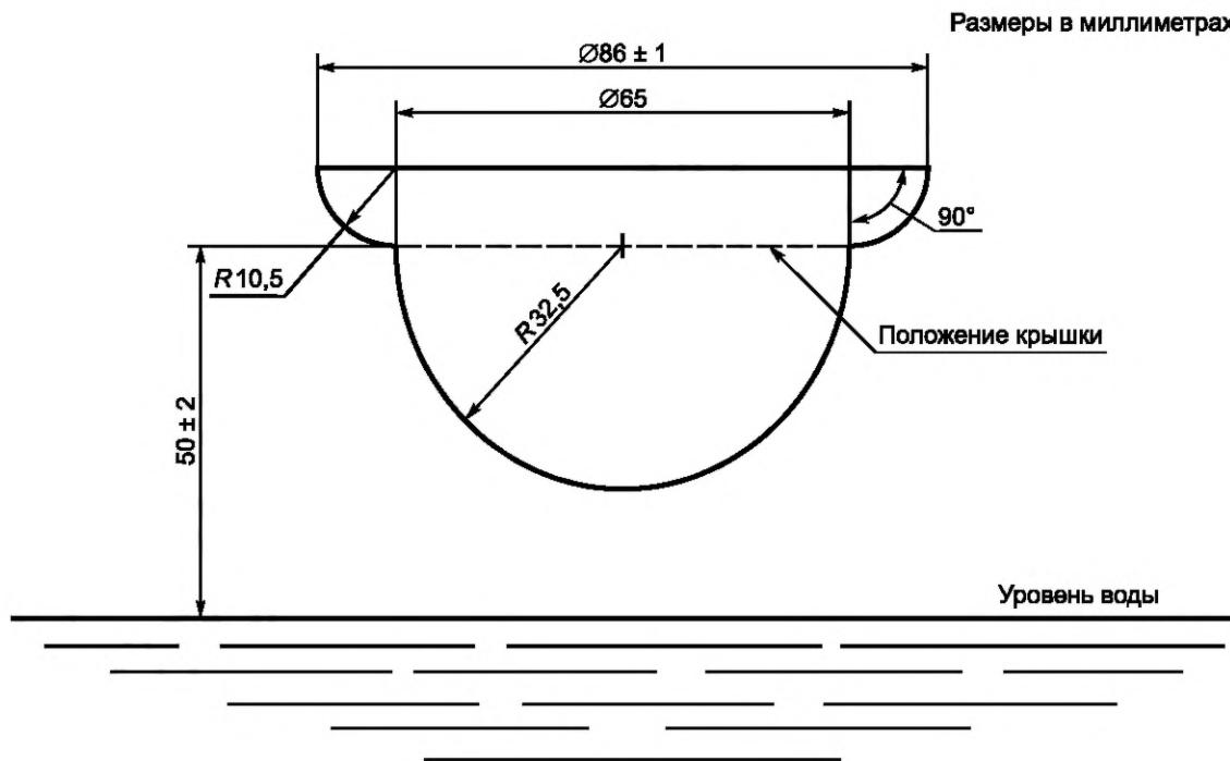
Рисунок — Чашка для выпаривания на водяной бане
