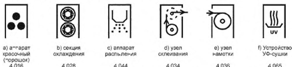
Рисунок A.7 — Примеры комбинирования базовых символов для обозначения секций и модулей, являющихся составной частью оборудования
