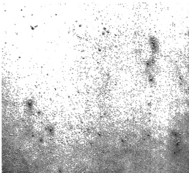
Рисунок 10 — Коррозия металла балл K2 (или Ri 2)
