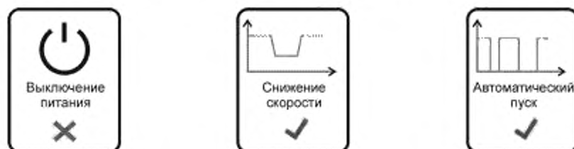
Рисунок 2 — Указатель режима работы эскалатора, указанного в примере 1
