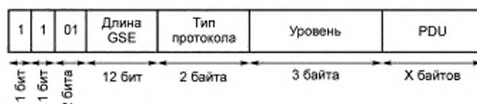
Рисунок В.2 — Пакет GSE, переносящий полный нефрагментированный PDU с 3-байтовым адресом NPA
