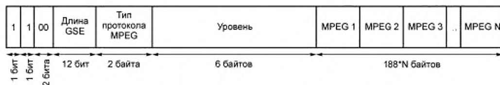
Рисунок В.5 — Пакеты сигнализации MPEG инкапсуляции GSE
