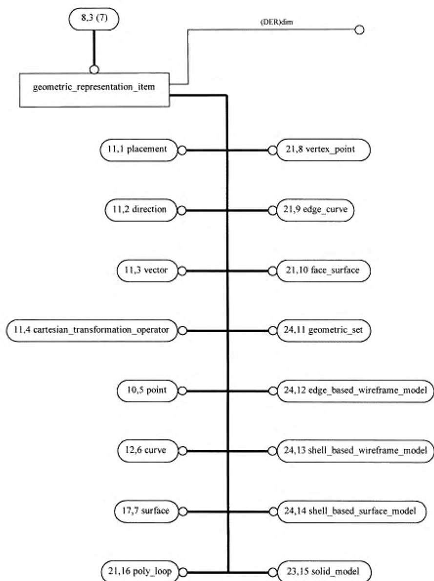
Рисунок Н.8 — geometric_representation_items — ПИМ EXPRESS-G диаграмма 8 из 39
