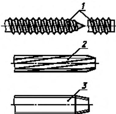
1 — винт саморежущий с острым и плоским концом; 2 — винт резьбонарезающий; 3 — винт резьбоформующий
