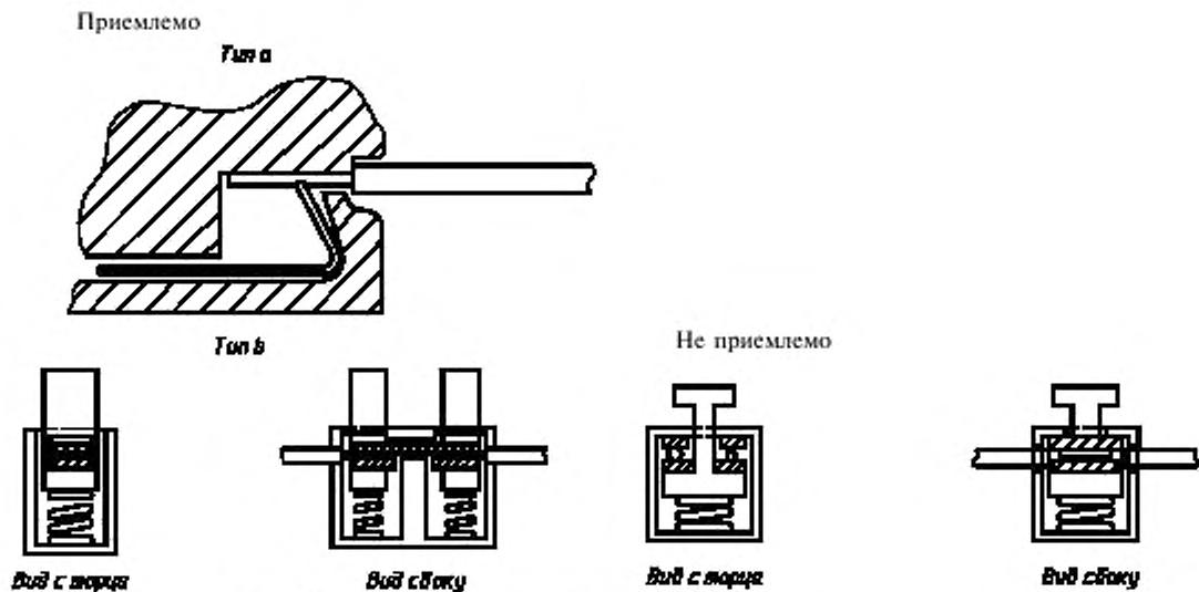
Рисунок 18 — Примеры безвинтовых контактных зажимов пружинного типа
