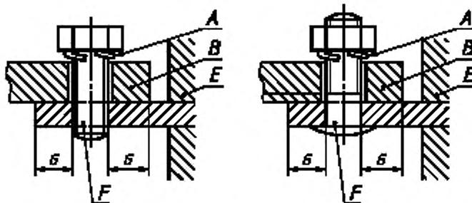
A — устройство защиты от самоотвинчивания; B — кабельный наконечник или плоский вывод; E — опорная деталь; F — шпилька;
