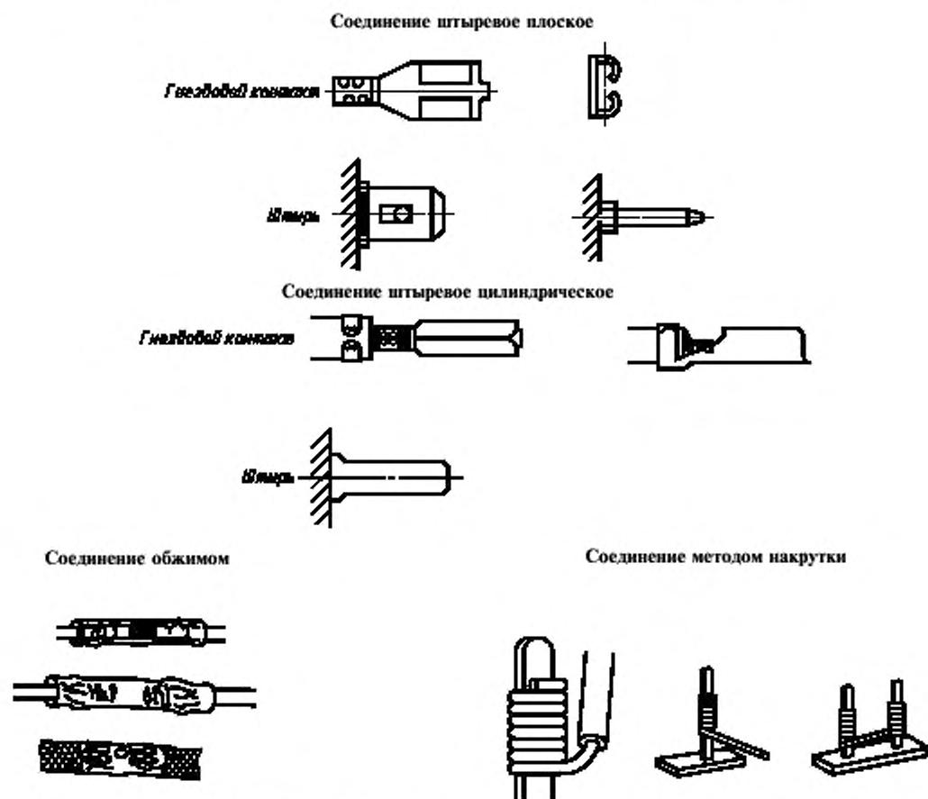
Рисунок 19 — Примеры безвинтовых соединений
