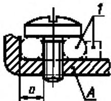
Винт, требующий шайбу или прижимную пластину
