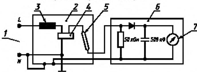
1 — сеть; 2 — светильник; 3 — ПРА; 4 — ИЗУ; 5 — лампа; 6 — измерительное устройство; 7 — высоковольтный вольтметр
