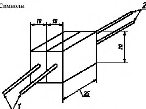
1 — кабели ввода; 2 — монтажные провода светильника
