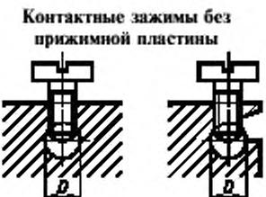
D — диаметр гнезда жилы провода
