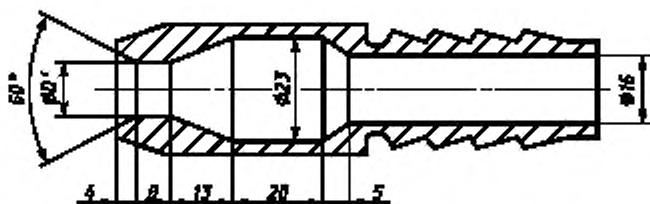
$D'$  = 6,3 мм для испытания по пункту 9.2.6 (вторая цифра в обозначении степени защиты 5),  $B'$  = 12,5 мм для испытания по пункту 9.2.7 (вторая цифра в обозначении степени защиты 5)
