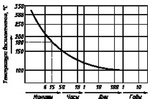
Рисунок 27 — Температура воспламенения дерева в функции времени
