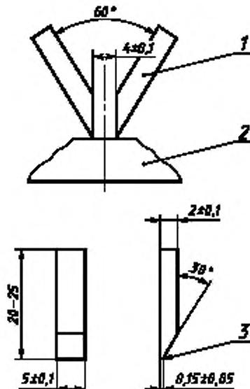
1 — электрод; 2 — образец; 3 — слегка скругленная кромка
