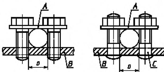
A — прижимная пластина; B — опорная деталь; C — шпилька;
