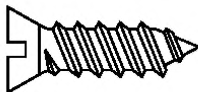
Рисунок А.6 — Самонарезающий формирующий винт
