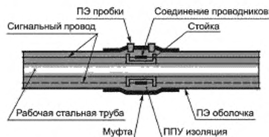
Рисунок 2 — Схема соединения сигнальных проводников в местах монтажных стыков
