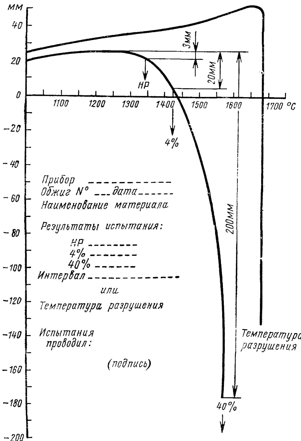
21. При наличии расхождений, превышающих  $20^{\circ}\text{C}$  и свидетельствующих о неравномерности нагрева печи, испытание во внимание не принимается и должно быть повторено.
