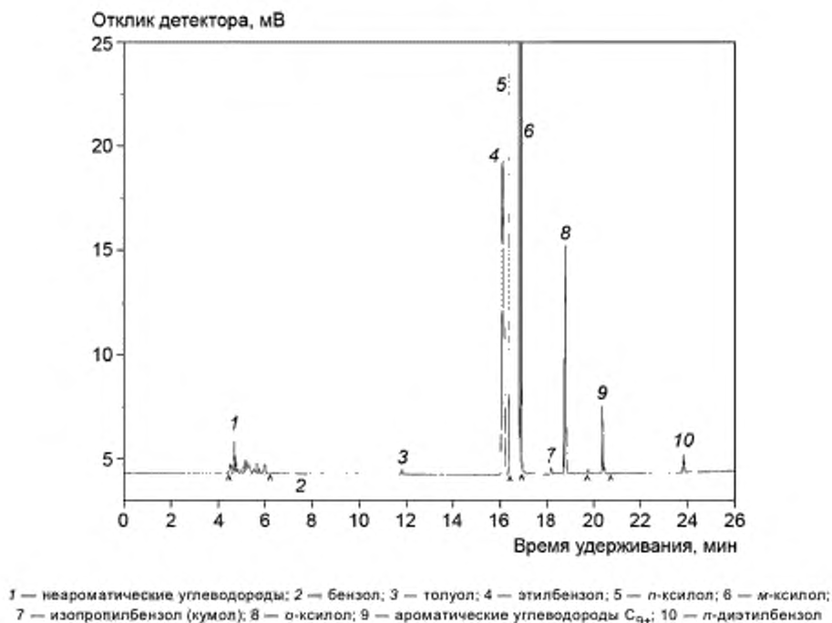
Рисунок 4 — Типичная хроматограмма p -ксилола по ASTM Д 5136
