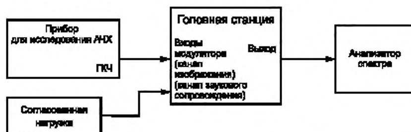
Рисунок 7.20 — Структурная схема для определения характеристики боковых полос
