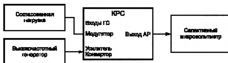
Рисунок 7.4 — Структурная схема для определения отношения радиосигнала изображения к шуму
