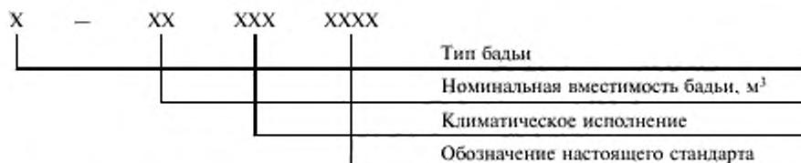
Пример условного обозначения бады проходческой для механизированной разгрузки, номинальной вместимостью 4,5 м<sup>3</sup>, для климатического исполнения У:
