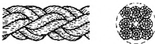
Рисунок 4 — Конфигурация 12-рядного плетеного каната (тип Т)
