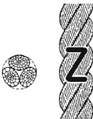
Рисунок 1 — Конфигурация 3-рядного крученого каната (тип А)
