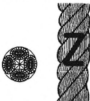
Рисунок 2 — Конфигурация 4-рядного крученого каната (тип В)
