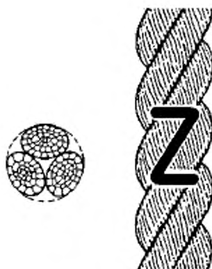
Рисунок 1 — Конфигурация 3-рядного крученого каната (тип А)
