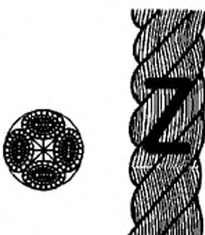
Рисунок 2 — Конфигурация 4-рядного крученого каната (тип В)
