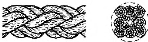
Рисунок 3 — Конфигурация 8-рядного плетеного каната (тип L)
