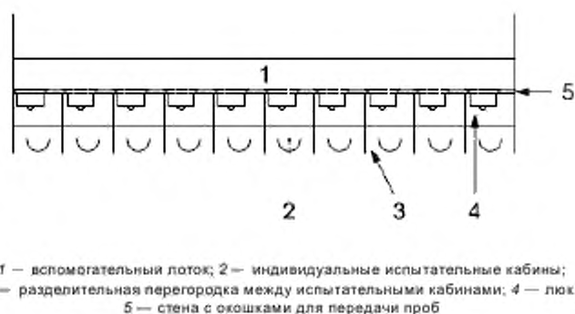
Рисунок А.7 — План расположения испытательных кабин и вспомогательных лотков, отделенного стеной
