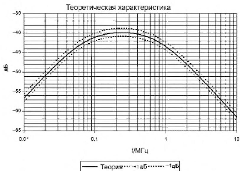
Рисунок F.3 – Вычисленная теоретическая характеристика для калибровки защитного контура
