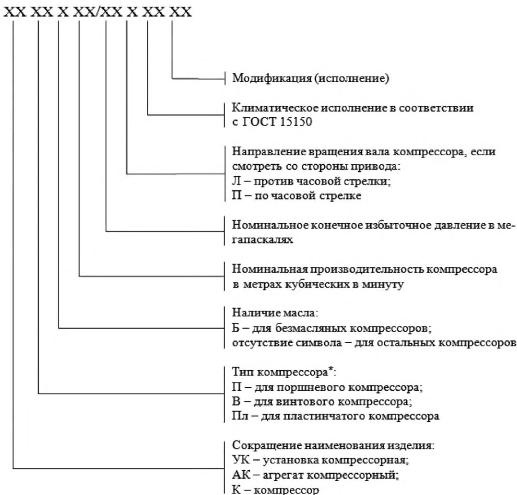
\* Для неуказанных типов компрессоров допускается построение обозначения по первым одной или двум согласным буквам их наименования по ГОСТ 28567.
