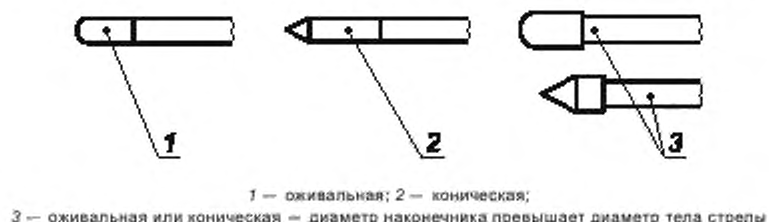
Рисунок 1 — Формы наконечников стрелы для спортивного лука и лука для отдыха и развлечений
