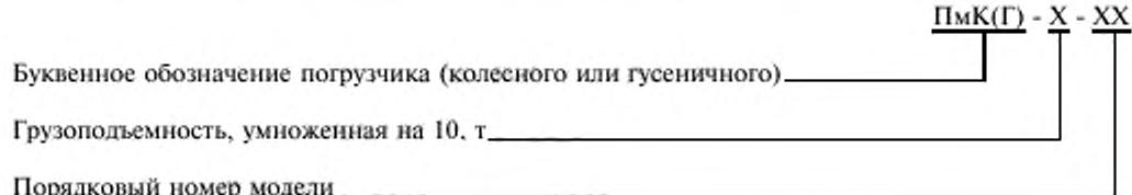
4.2.1 Пример индексации малогабаритного колесного погрузчика грузоподъемностью 0,6 т третьей модели:
