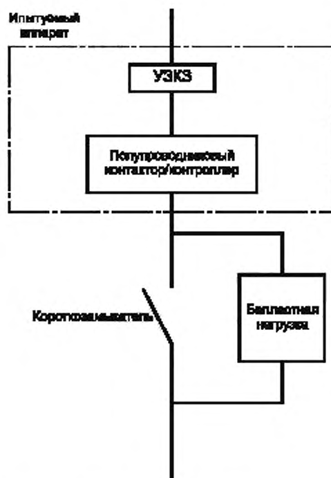
Рисунок 1.1 — Модифицированная цепь для испытания на короткое замыкание полупроводниковых аппаратов
