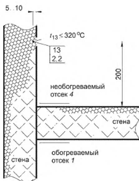
Рисунок Д.5 — Температура в контрольной точке 13 и схема распространения горения из отсека 1 по стенам отсеков 1 и 4, вид сверху
