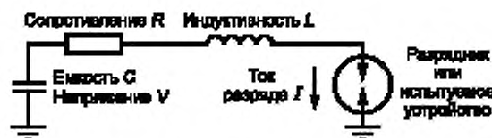
Рисунок 5 — Принципиальная схема устройства для моделирования разрядов статического электричества
