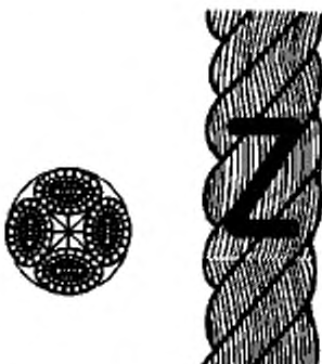
Рисунок 2 - Конфигурация 4-рядного крученого каната (тип В)
