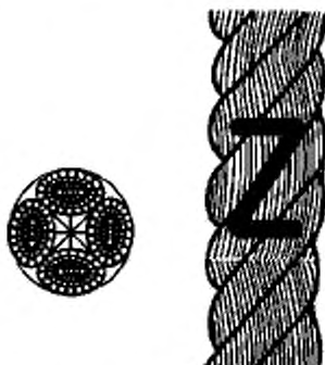
Рисунок 2- Конфигурация 4-рядного крученого каната (тип В)
