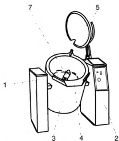
а) Котел с нижним приводом мешалки
