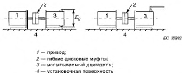
Рисунок А.4 — Подготовка испытаний для определения коэффициента противоЭДС
