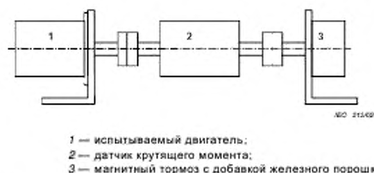
Рисунок В.2 — Испытательный стенд для измерения опрокидывающего момента при помощи датчика крутящего момента и магнитного тормоза с добавкой железного порошка
