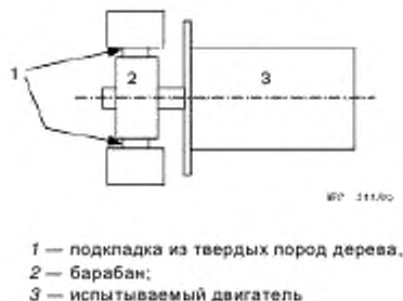
Рисунок В.1 — Способ определения скорости втягивания
