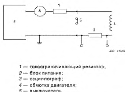
Рисунок А.6 — Схема измерения индуктивности методом разрядного тока
