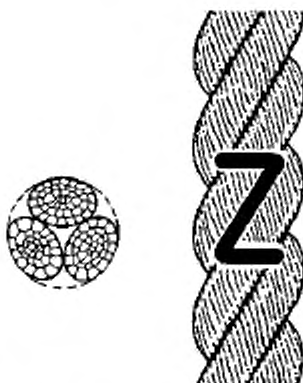
Рисунок 1- Конфигурация 3-рядного крученого каната (тип А)
