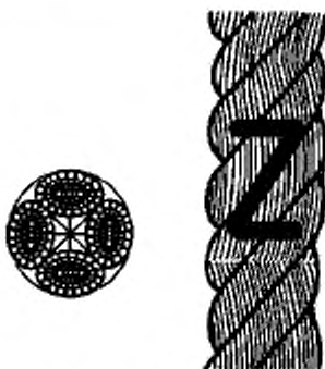
Рисунок 2- Конфигурация 4-рядного крученого каната (тип В)
