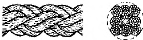
Рисунок 3- Конфигурация 8-рядного плетеного каната (тип L)
