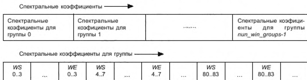
Рисунок 2 — Порядок спектральных данных для EIGHT_SHORT_SEQUENCE
