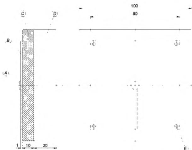
A — термопара крепится к центру медной пластины; B — квадратная медная пластина;
