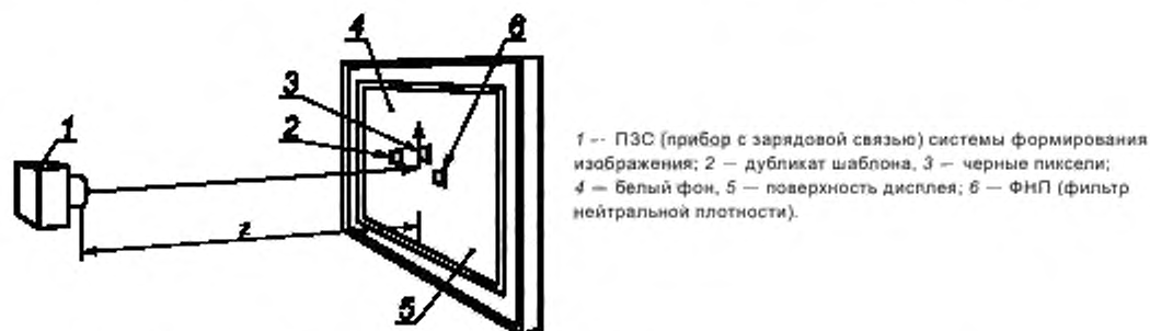
Рисунок 4 — Использование дубликата шаблона для компенсации вуалирующей блескости
