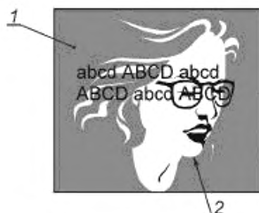
Рисунок 57 — Пример нежелательных зеркальных отражений
