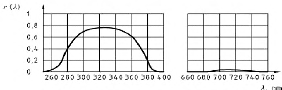
Рисунок В.2 – Спектральный коэффициент пропускания УФ-фильтра
