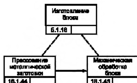
Рисунок В.3 — Процесс изготовления блока изделия GT-350
