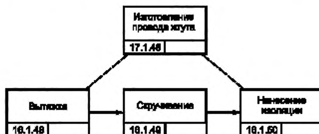
Рисунок В.5 — Процесс изготовления провода жгута
