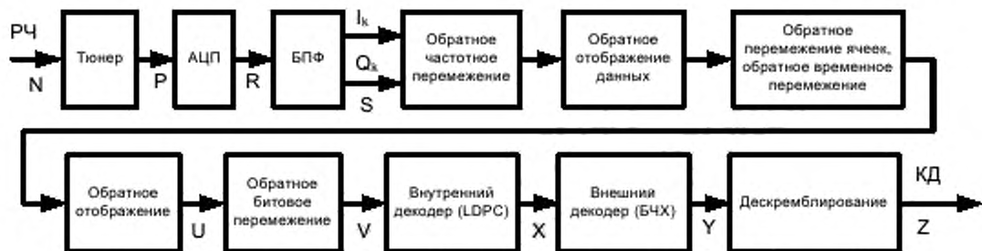
Рисунок 2 – Функциональная схема приемной части системы RABIS (приемник)
