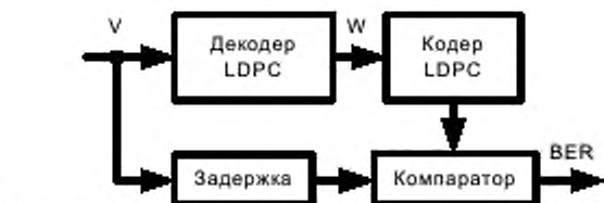
Рисунок 6 – Измерение BER до канального декодера LDPC
