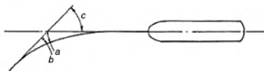
Рисунок Г.2 — Определение угла остаточной деформации
